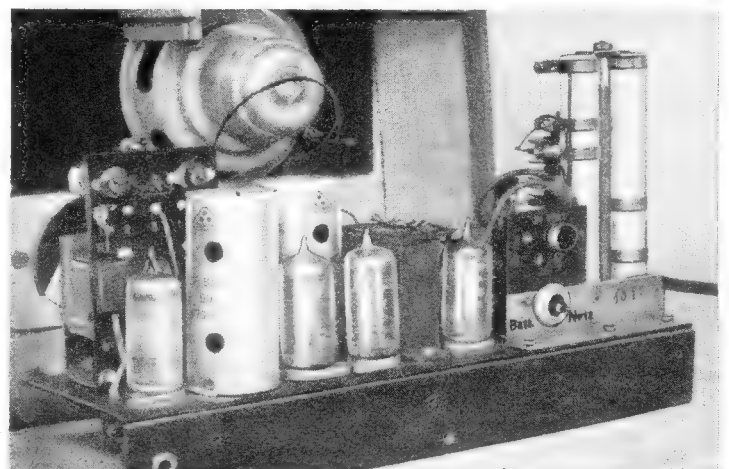
Schaltung des 6-Kreis-4-Röhren Koffersuperhets »Wochenend« für Batterie- und Allstrombetrieb. Hersteller des Basatzes: Willy Hütter, Nürnberg-O., Mathildenstraße 42
